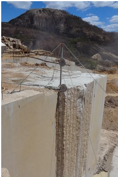
Operação de fio diamantado na lavra de granito. Foto: Cid Chiodi Filho
